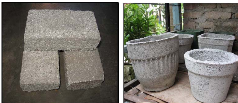
Gambar 5: Penghasilan batu bata dan pasu bunga di Indonesia dengan komposisi 1 simen, 3 pasir, 3 styrofoam dan air.
